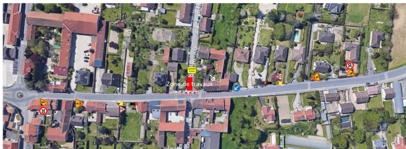
Mise en place d'un alternat par feux pour les travaux au niveau de la rue de la paix - RD8
